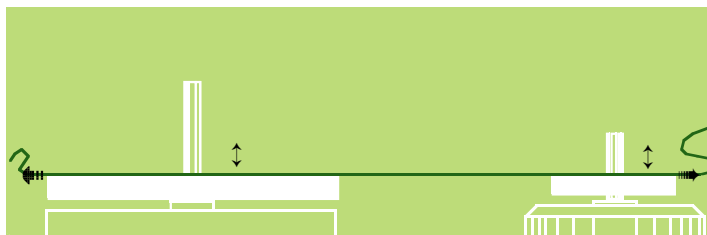
Fig:1 Parallellitet kontrolleras med linjal eller riktsnöre
